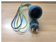
**Adapter für direkte Berührstrommessung**
